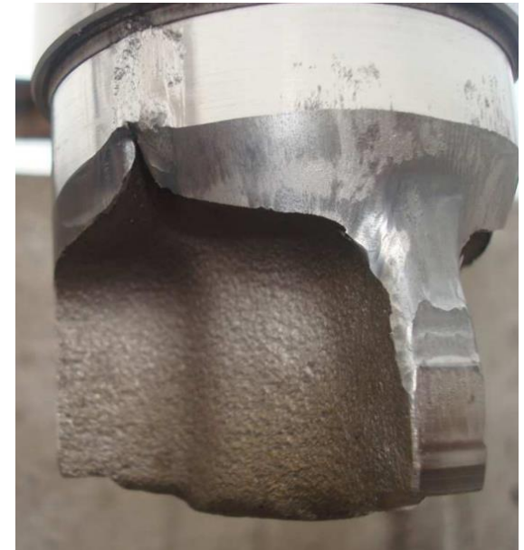
Schädigungsbild eines Drosselkörpers
