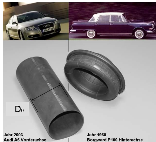
Abb. 1: Gegenüberstellung Vibracoustic Lufffederschlauch mit 1.6 mm Wanddicke gegenüber dem Phoenix Elastomerformteil aus dem Jahr 1960 mit einer Wandstärke > 4 mm.
