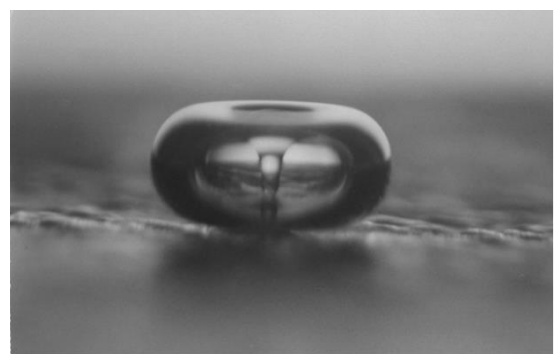
Bild 1: Hochgeschwindigkeitsaufnahme einer implodierenden Kavitationsblase.
